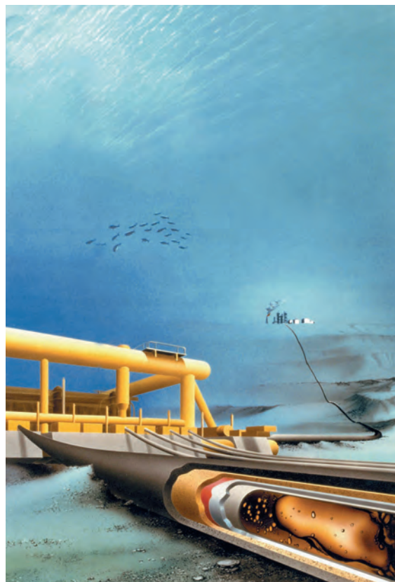
Norsk forskning på flerfase siden 1980 var en forutsetning for å kunne føre olje og gass i rør over 143 km direkte fra brønnen på Snøhvit til prosessanlegget på land på Melkøya ved Hammerfest. Illustrasjon: Equinor
