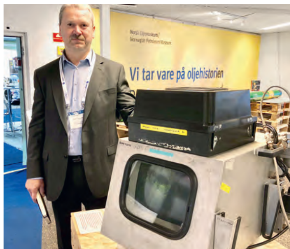
Ingulf Egeland jobbet med å lage denne eksplosjonssikre datamaskinen våren 1987. -Teknologisk sett var det dette vi hadde mulighet til den gang. Det ble en forløper for teknologi som er utviklet seinere. I dag utføres oppgavene denne gjorde med en enhet på størrelse med en iPad, forteller han. Egeland syntes det var stas å se datamaskinen igjen på ONS i 2018. Foto: Anja W. Fremo/Norsk Oljemuseum
