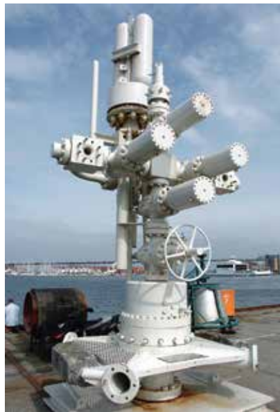
De fire ventiltrær som produserte olje på havbunnen på Ekofisk i 1971 måtte betjenes manuelt av dykkere. Et av dem er bevart og står på kaien utenfor Norsk Oljemuseum. Foto: Norsk Oljemuseum
