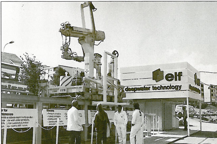
Fra ONS 1982. TIM (Telemanipulator for Intervention and Maintenance) ble konstruert for de spesielle behov ved undervannsstasjonen Grovndin Nordøst, som var et viktig testområde.
